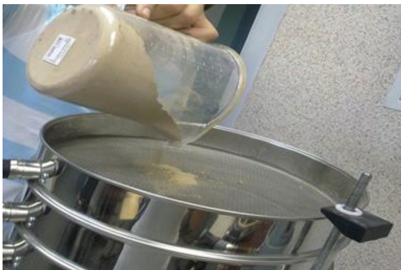
Рисунок 3. Определение гранулометрического состава бентонита на вибросите
