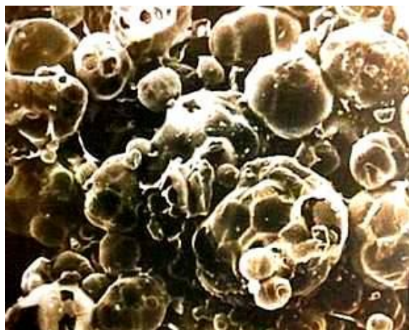
Рисунок 1. Покрытие TC Ceramic HV под электронным микроскопом
