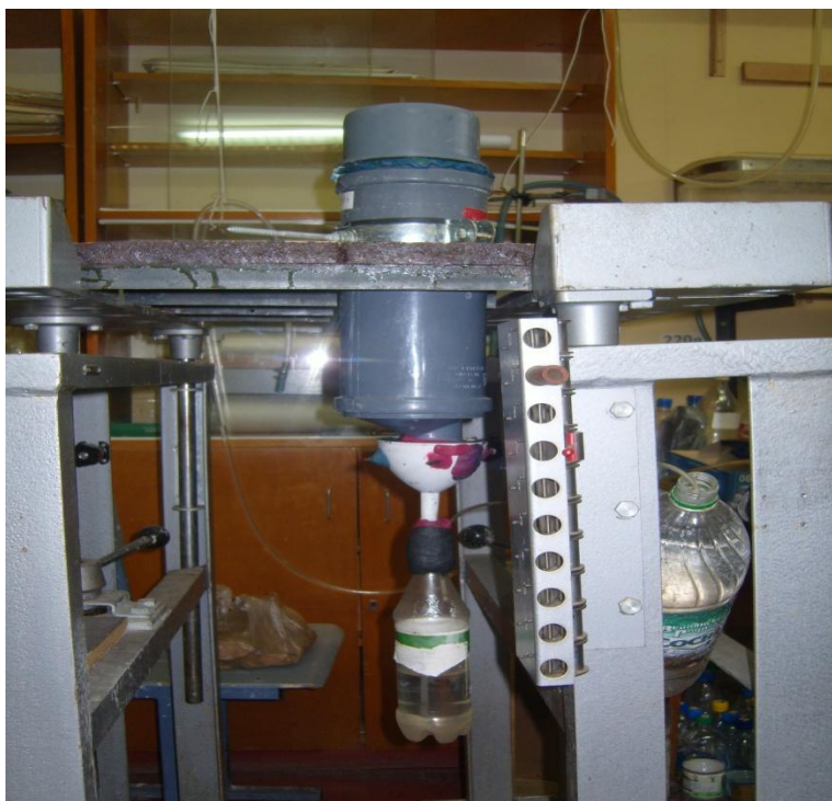
Рисунок 2. Опыт по изучению просачивания индикаторного раствора через монолит днепровской морены в лаборатории гидрогеохимических исследований
