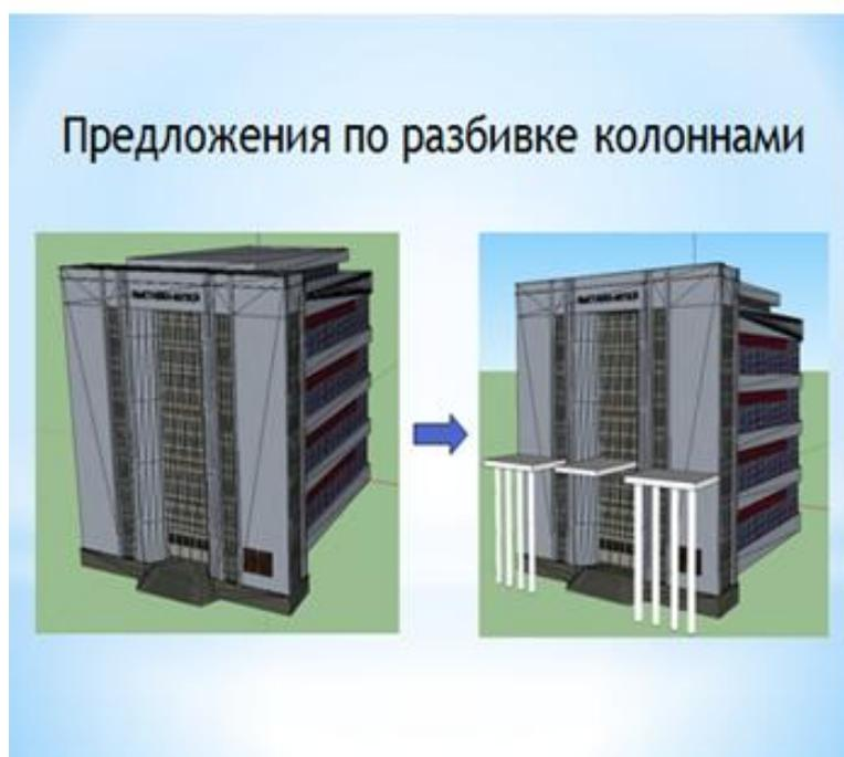
*Рисунок 2. Предложения по разбивке больших плоскостей колоннами*
