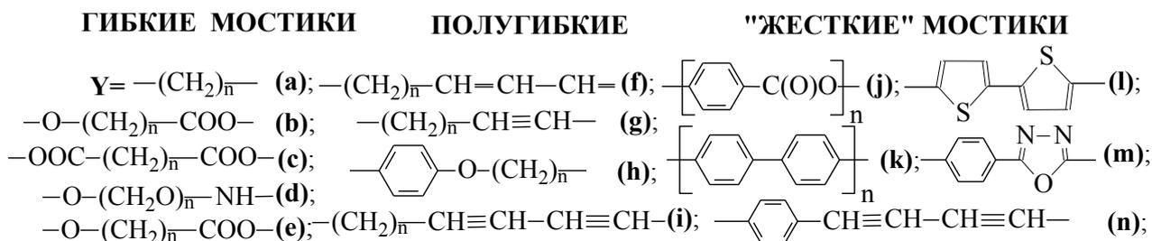
**Рисунок 3. Примеры типичных мостиковых групп, используемых в конструировании ЗДМ (a – e) — гибкие; (f – i) — полугибкие; (j – n) — «жесткие»**
