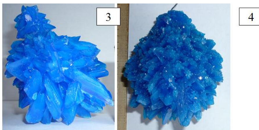
Рисунок 4. Форма и размеры кристаллов CuSO_4 \cdot 5H_2O : В — 3 (3) — неправильное скопление друз; В — 4 (4) — круглая елочка
