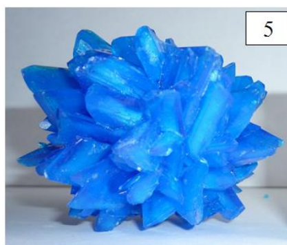
Рисунок 5. Форма и размеры кристаллов \text{CuSO}_4 \cdot 5\text{H}_2\text{O} : В — 5 (5) — собрание крупных кристаллов
