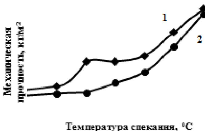
**Рисунок 5. Зависимость механической прочности спеченных материалов на основе алюмосиликатов Приморского месторождения от температуры SPS-спекания, порошки алюмосиликатов: 1 — насыщенный влагой из атмосферы; 2 — предварительно прокаленный на воздухе при 150<sup>0</sup>С**
