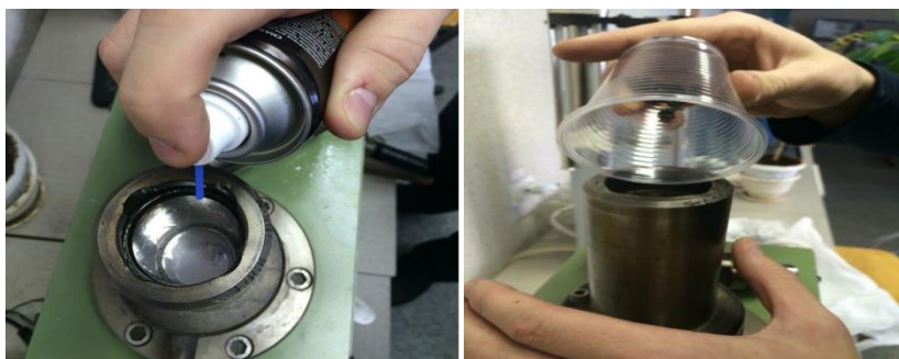
Рисунок 2. Покрытие силиконовой смазкой формы и ее заполнение
