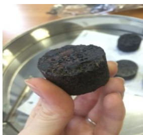
Рисунок 5. Брикет с выдержкой 5 минут под давлением после 7 ударов
