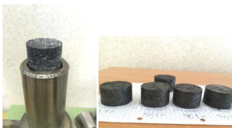
Рисунок 3. Брикеты, спрессованные из металлизированной мелочи и шлама цеха №1 ГБЖ ОАО «ЛГОК»
