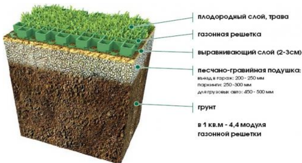
Рисунок 1. Строение экопарковки в разрезе [1].
