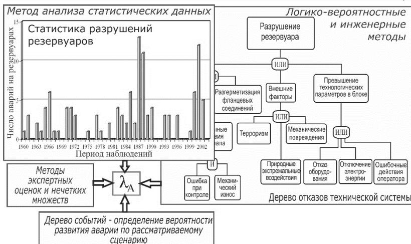
**Рисунок 7. Методы определения частоты аварии на потенциально опасном объекте**
