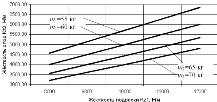
**Рисунок 2. Жёсткость  $K_{z2}$  опор машины в зависимости от жёсткости подвески  $K_{z1}$**
