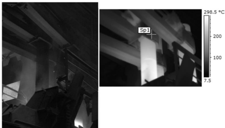
Рисунок 1. Электрододержатели дуговой сталеплавильной печи ёмкостью 10 т и их термограмма (температура в точке 1—70 °С)
