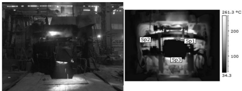
Рисунок 9. Общий вид дуговой сталеплавильной печи ёмкостью 10 т и её термограмма (температура в точке 1—165 °С, в точке 2—150 °С, в точке 3—150 °С)
