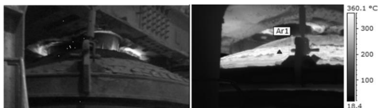
Рисунок 6. Свод дуговой сталеплавильной печи ёмкостью 5 т и термограмма обследуемого участка (температура в точке 1—360 °С)
