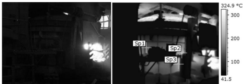
Рисунок 7. Загрузочное окно и его привод дуговой сталеплавильной печи ёмкостью 10 т и термограмма обследуемого участка (температура в точке 1—140 °С, в точке 2—230 °С, в точке 3—190 °С)
