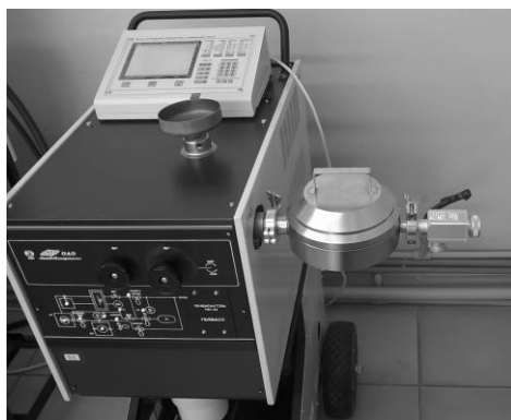
Рисунок 1. Вакуумная камера, установленная на течеискателе ТИ 1-22 «ГЕЛМАСС»
