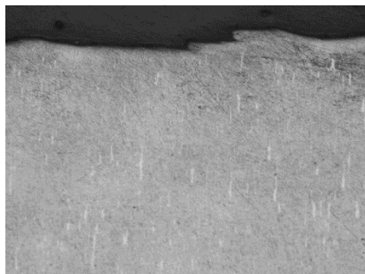
Рисунок 3 Микроструктура стали 14X17H2 до ультразвукового упрочнения, x100
