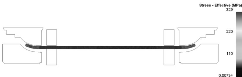
**Рисунок 2. Общий вид процесса после подгибки кромок (разгрузка)**
