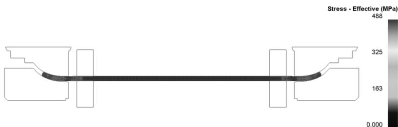
**Рисунок 1. Общий вид процесса при подгибке кромок (нагрузка)**
