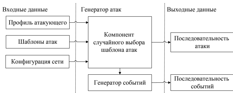
Рисунок 1. Архитектура генератора случайных последовательностей атаки
