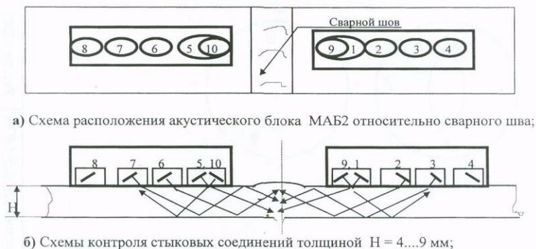
Рисунок 1. Схема контроля дефектоскопа «Скаруч»
