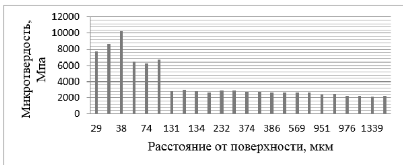
Рисунок 4. Микротвёрдости стали Ст3 по глубине после цементации при нагрузке P = 2H
