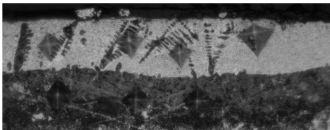
Рисунок 3. Микроструктура стали Ст3 после цементации с увеличением 400 раз
