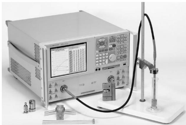
**Рисунок 3. Установка с использованием коаксиальных пробников**
