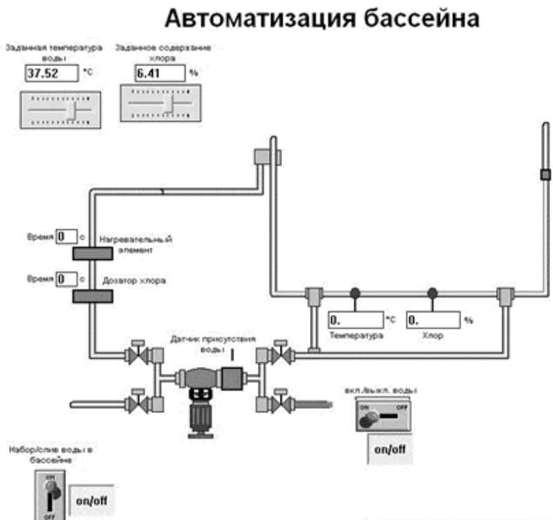
Рисунок 5. Система автоматизации бассейна без подачи воды
