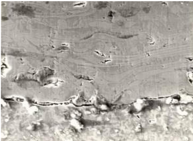
Рисунок 3. Хромовое покрытие, нанесенное газопламенным способом на стальной образец. Увеличение x400
