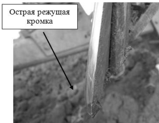
Рисунок 5. Внешний вид лемеха плуга с защитным покрытием после 120 Га наработки. Износа 3,1 мм, отсутствие затупления режущей кромки
