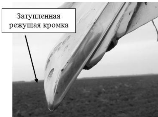
Рисунок 4. Внешний вид лемеха плуга без защитного покрытия после 120 Га наработки. Износ 8,4 мм, затупление режущей кромки
