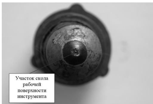
Рисунок 1. Рабочая поверхность инструмента с обозначением поврежденного участка в виде скола
