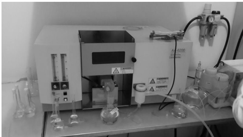
Рисунок 1. Атомно-абсорбционный спектрофотометр AA-6200
