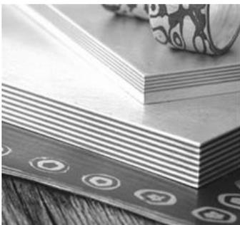
*Рисунок 2. Плоские заготовки до скручивания слоев*
