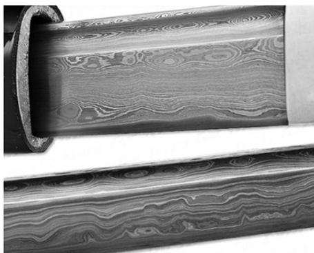
*Рисунок 1. Лезвия катаны, изготовленной в технике мокуме гане*
