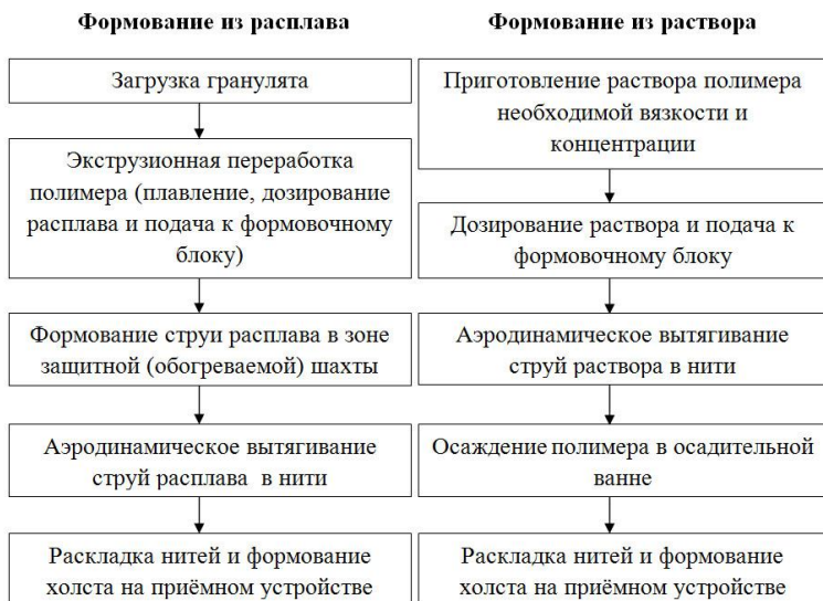
Рисунок 1. Принципиальная схема способа аэродинамического формования из полимерных расплавов и растворов
