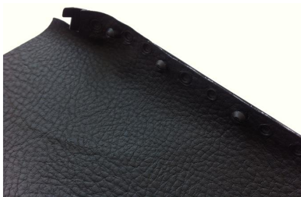
Рисунок 3. Крепление элементов деталей с помощью ультразвуковой сварки
