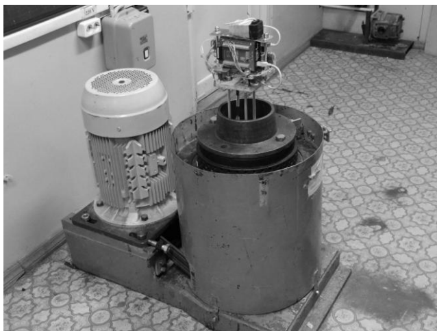
Рисунок 3. Пресс-гранулятор с тензометрической системой, смонтированной на силоизмерительном прессующем ролике (крышка кожуха снята)
