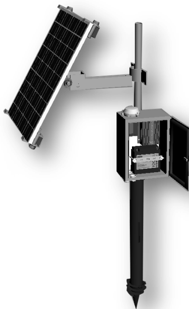
Рисунок 4. Станция мониторинга уровня воды в водоеме
