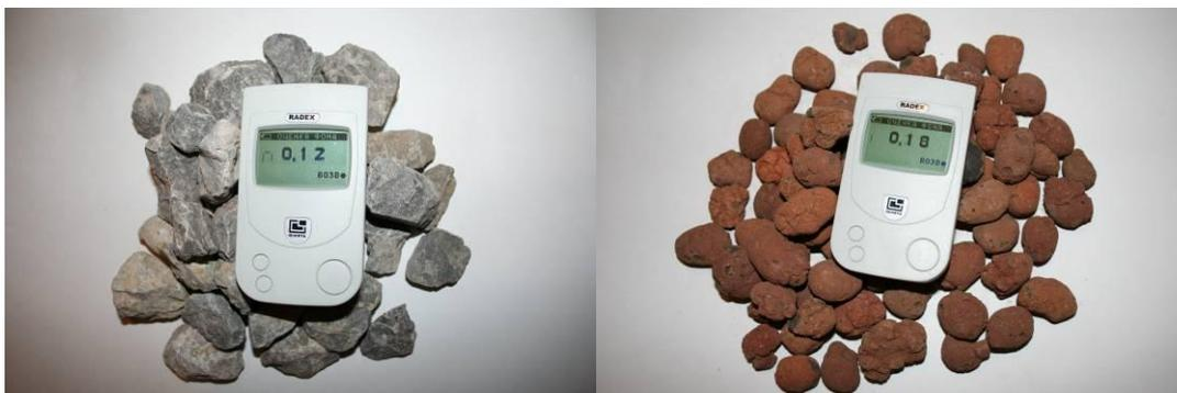
***Рисунок 4. Замеры радиационного фона проб щебня и керамзита бытовым дозиметром «РАДЕКС» РД1706***
