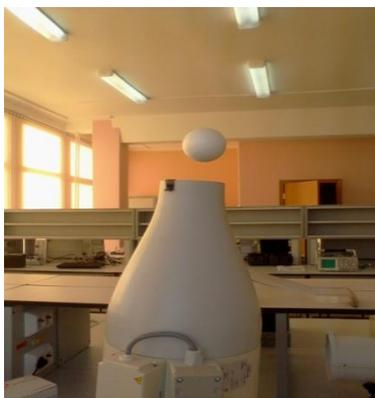
*Рисунок 6. «Парение» шара экспериментальной трубой, создающий воздушный поток*
