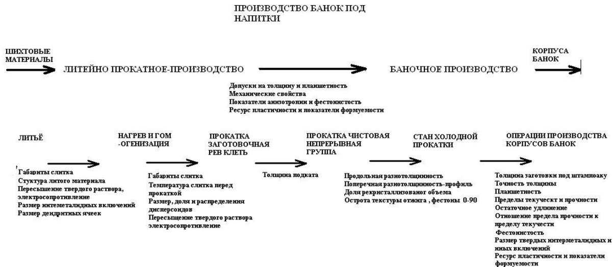
*Рисунок 1. Материальный поток при производстве корпусной баночной ленты из сплава 3104*
