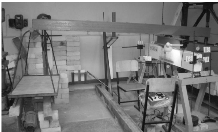
Рисунок 1. Общий вид испытаний составных железобетонных балок
