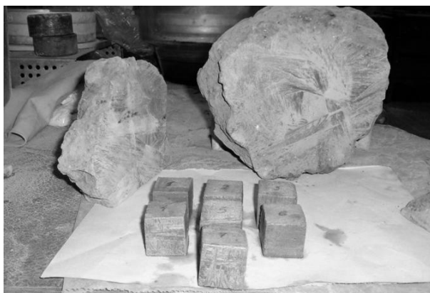
Рисунок 1. Образцы грунтоцементных свай отобранные путем распиловки откопанных свай
