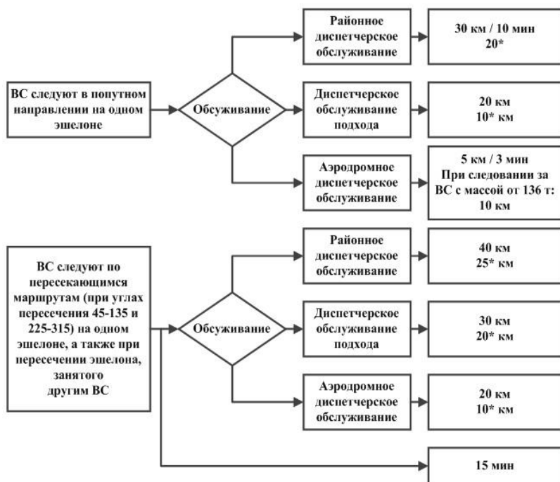
Рисунок 5. Нормы продольного эшелонирования между воздушными судами на одном эшелоне полета
