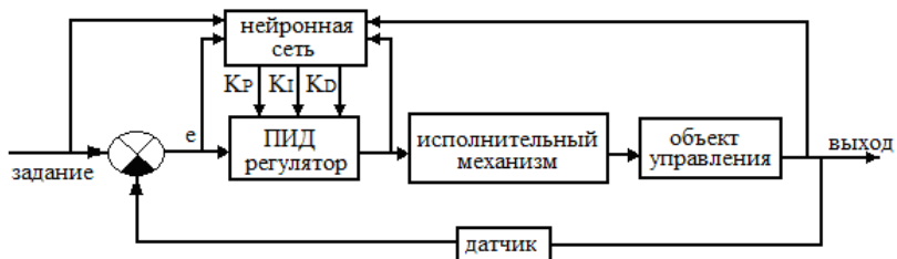
Рисунок 1. Схема нейросетевого управления с самонастройкой
