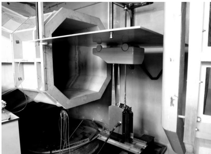
***Рисунок 2 Модель автомобиля в аэродинамической трубе***
