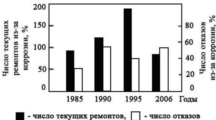
**Рисунок 1** Диаграмма аварийности скважинного оборудования в ОАО «ТНК-ВР»
