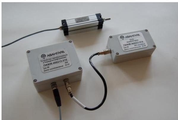
***Рисунок 5. Общий вид мота беспроводной сенсорной сети ZigBee на основе потенциометрического сенсора СМД-ДП-1***
