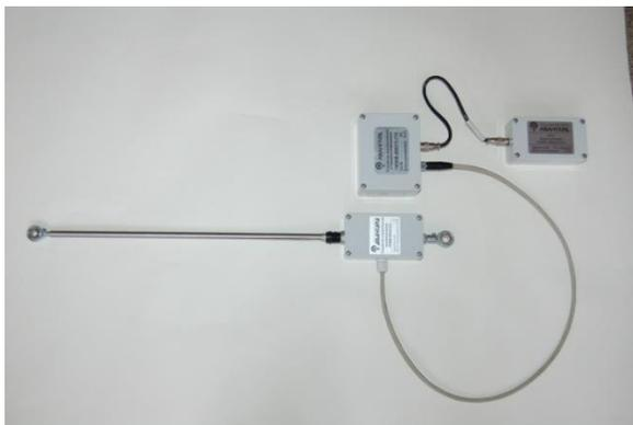
***Рисунок 4. Общий вид мота беспроводной сенсорной сети ZigBee на основе тензометрического сенсора с полумостовой схемой СМД-ДТ-1***
