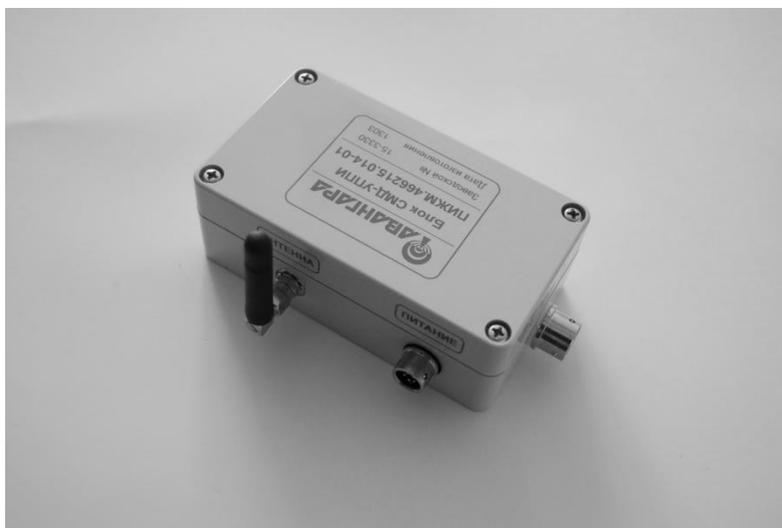
*Рисунок 2. Устройство приема и передачи информации (УППИ) мота беспроводной сенсорной сети СМД*
