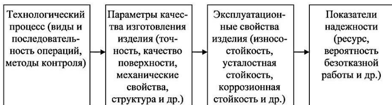
Рисунок 1. Схема зависимости показателей надежности от уровня технологического процесса
