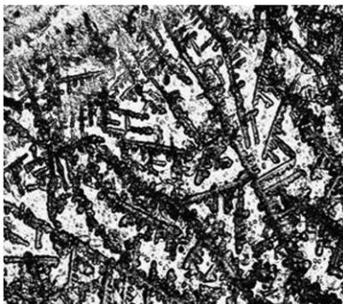
*Рис. 14. Налипание органических включений на микрокристаллы.*
