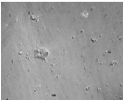
***Рисунок 1. Морфология поверхности кварцевого стекла с технологическими дефектами. ×500***
