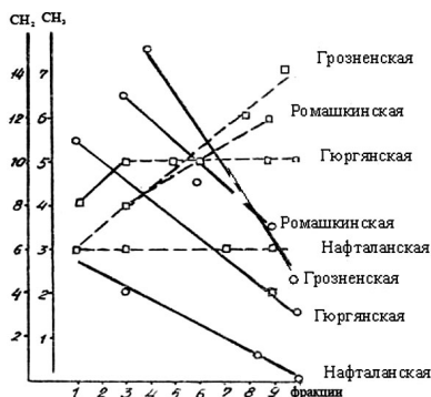
Рис. 1. Изменение количества групп СН 2 и СН 3 во фракциях термодиффузионного разделения нафтеновых углеводородов с выкипаемостью 350—420° различных нефтей
