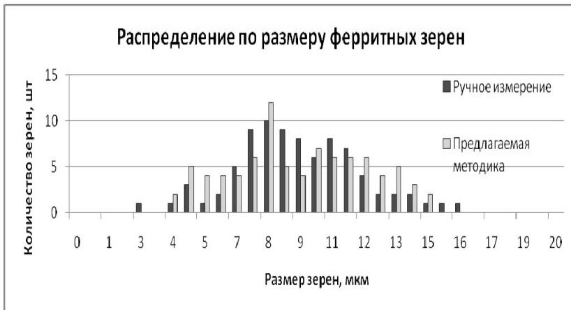
Результаты работы метода показывают хорошее соответствие эталонным замерам, выполненным вручную. Помимо устойчивого приемлемого результата, описанная методика позволяет значительно упростить, ускорить и удешевить работы, связанные с контролем качества выпускаемой продукции, контролем технического состояния находящихся в эксплуатации различных металлоконструкций и сооружений без применения методов разрушающего контроля.
