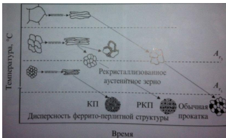
Рисунок 1 Схема влияния температуры деформации при контролируемой прокатке на морфологию аустенитного зерна и ферритно-перлитную структуру в малоуглеродистых микролегированных сталях
